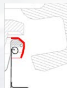
Im ersten Arbeitsgang wird der Deckel inklusive Spannring auf den Rumpf gelegt.
